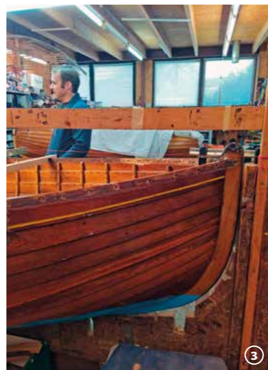
1. Gertjan van der Meer legt de meetprocedure uit. 2. De jol ligt klaar om te meten. 3. Met de steven in de bouwmal. 4. De kielbalk rust op de bouwmal. 5. Ondanks het herstel blij je van de schade altijd iets zien. FOTO'S JAAP WIJNTJES
